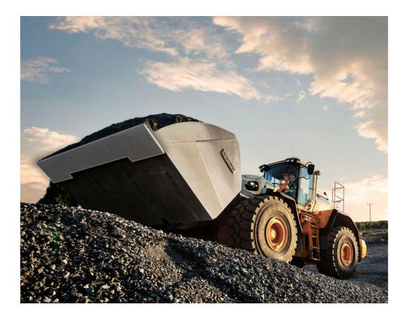
Tx G.E.T.'S COMBINATION OF HARDNESS AND TOUGHNESS IS THE KEY. BUILT FROM HIGH TENSILE BORON STEEL, OUR **50MM CUTTING EDGES WILL PERFORM NO MATTER THE** SITUATION AND WILL LAST THE DISTANCE.
